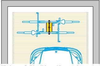
Mit einem zusätzlichen Haltearm können an einem Ständer zwei Fahrräder befestigt werden.
